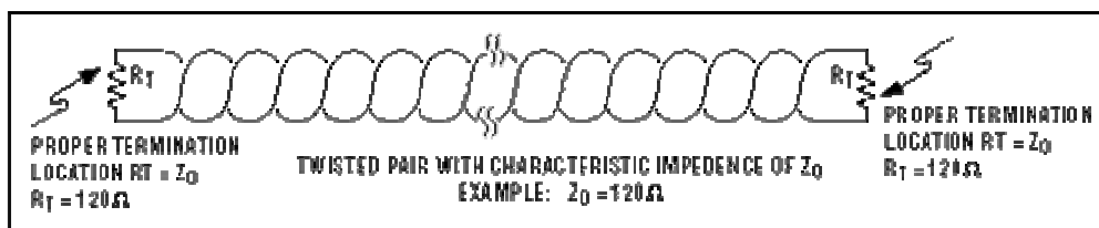
Рис. 4. Согласующие резисторы должны иметь сопротивление, равное волновому сопротивлению витой пары и должны размещаться на дальних концах кабеля.
